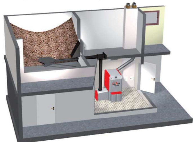
Magazzino e vano tecnico su piani diversi. Agitatore orizzontale con coclea e tubo a caduta.
