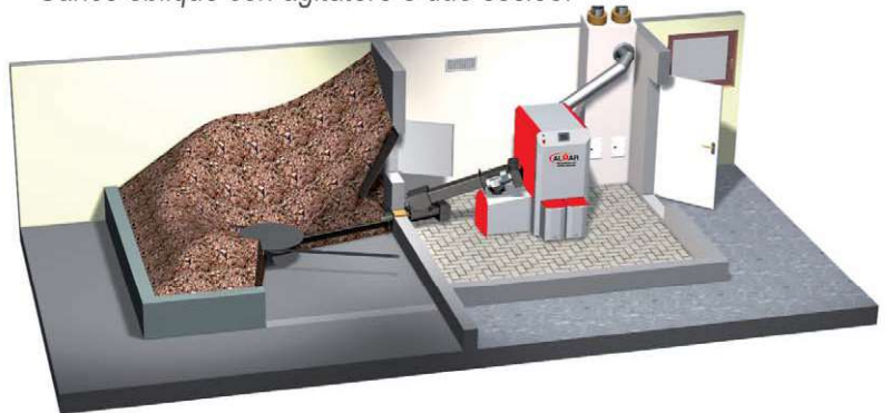
Estrazione da magazzino con agitatore orizzontale con coclea obliqua per svuotare al meglio il magazzino.
