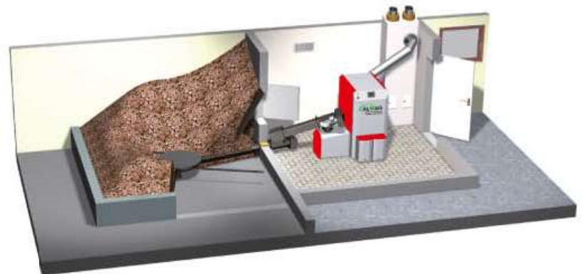
Raumaustragung über waagrechtes Federrührwerk mit Steigschnecke zur optimalen Lagerraumausnutzung
