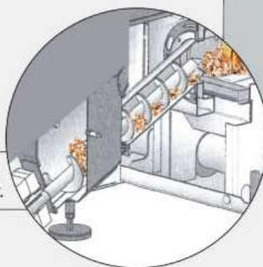
Seitlicher Einschub von Hackgut oder Pellets in die Brennkammer.
