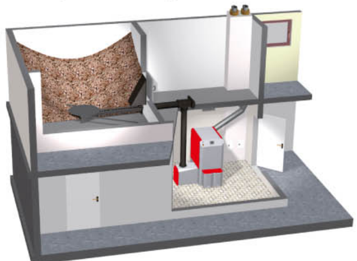
Lagerraum und Heizraum auf unterschiedlichem Niveau. Waagrechte Austragung mit Federrührwerk und Fallschacht.
